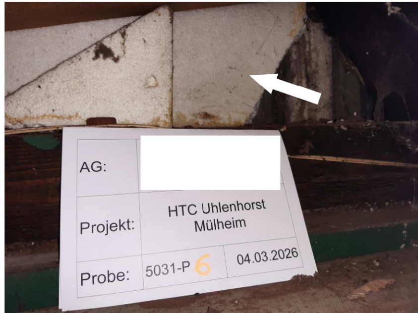
Probe-Nr. 5031-P6 Polystyrol-Dämmplatten, Außenwand über Abstellkammer Hockeyhalle HBCD-Gehalt 4.400 mg/kg
